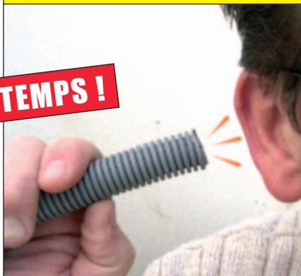
La boîte à son\* permet de repérer (en étant seul ou à deux) les gaines électriques (diamètres de 16 à 32 mm) par un moyen sonore (Buzzer). Afin d'éviter que l'électricien souffle ou crie dans une gaine électrique pendant que son équipier essaie de la retrouver à son autre extrémité, la boîte à son émet un signal sonore puissant. Pratique quand il faut par exemple retrouver des gaines aux repères disparus.
